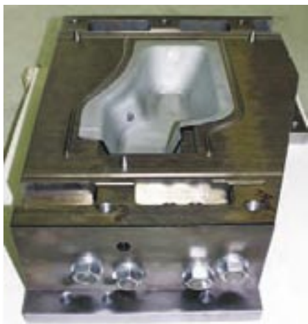
Bild 1: Karosserieblech, bereits 60000 Teile gefertigt, Größe L x B x H 575 x 385 x 139 mm
