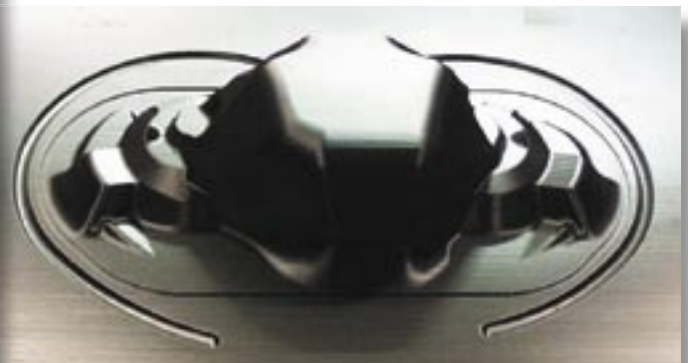
Bild 9: bis jetzt 140.000 Prägungen, Größe 800 x 412 x 600 mm
