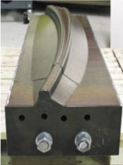
Bild 7: PresshärteWZ mit konturnahen Kanälen
